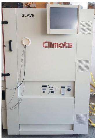
*Рисунок 3. Климатическая камера*
