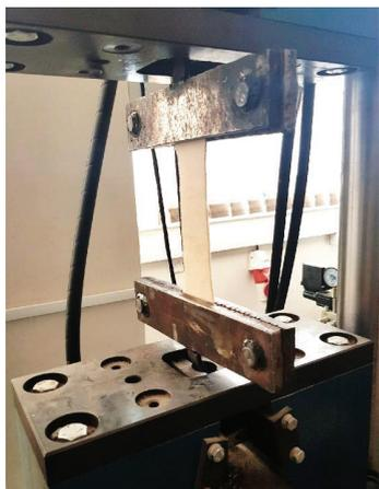
*Рисунок 2. Испытание образца по определению предела прочности на растяжение и относительного удлинения при разрыве*
