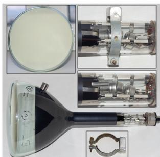
*Рисунок 5 - Кинескоп 18ЛК15Б, изготовленный запрудненским заводом «ЗЭЛТА» в 1959 году, прожектор которого имеет ионную ловушку (см. пояснения по тексту)*
