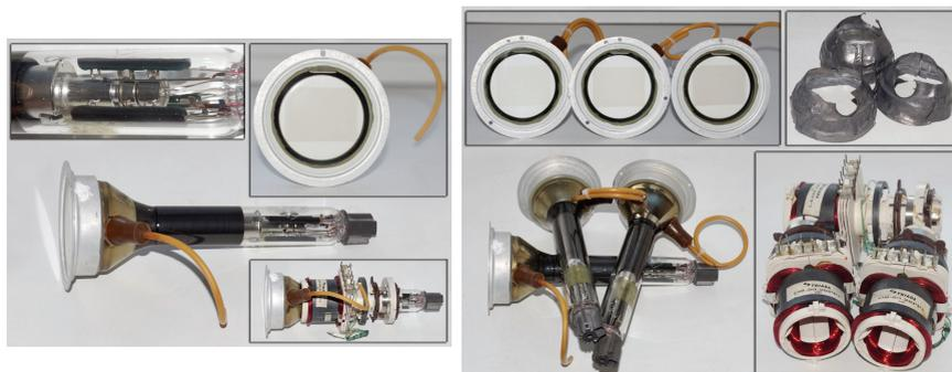
*Рисунок 6 - Проекционные кинескоп 6ЛП1А (слева) и вся тройка 6ЛП1П, 6ЛП1И, 6ЛП1А. На маленькой врезке (слева) показан кинескоп с установленной на него отклоняющей системой*
