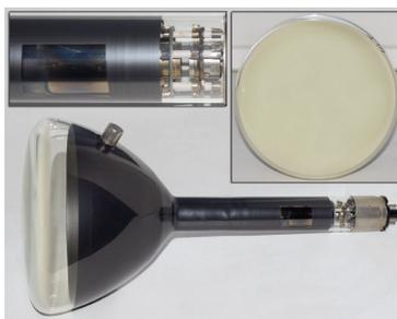
*Рисунок 4 - Кинескоп 18ЛК15, изготовленный московским заводом «МЭЛЗ» в октябре 1955 года*
