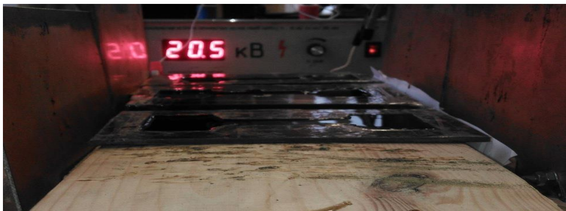
Рис. 2. Установка для получения композитов с ориентацией электрическим полем высокой напряженности
