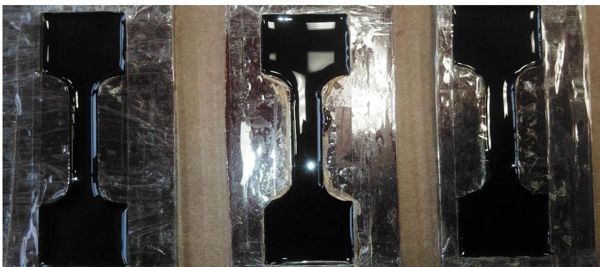
Рис. 3. Образцы полимеров с углеродными нанотрубками, полученные с помощью ориентации полем и без ориентации для проверки механических и электрических свойств
