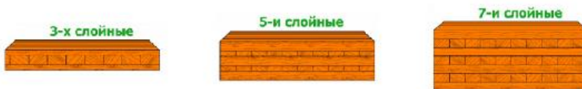
Рис. 1. Плиты перекрытия CLT
