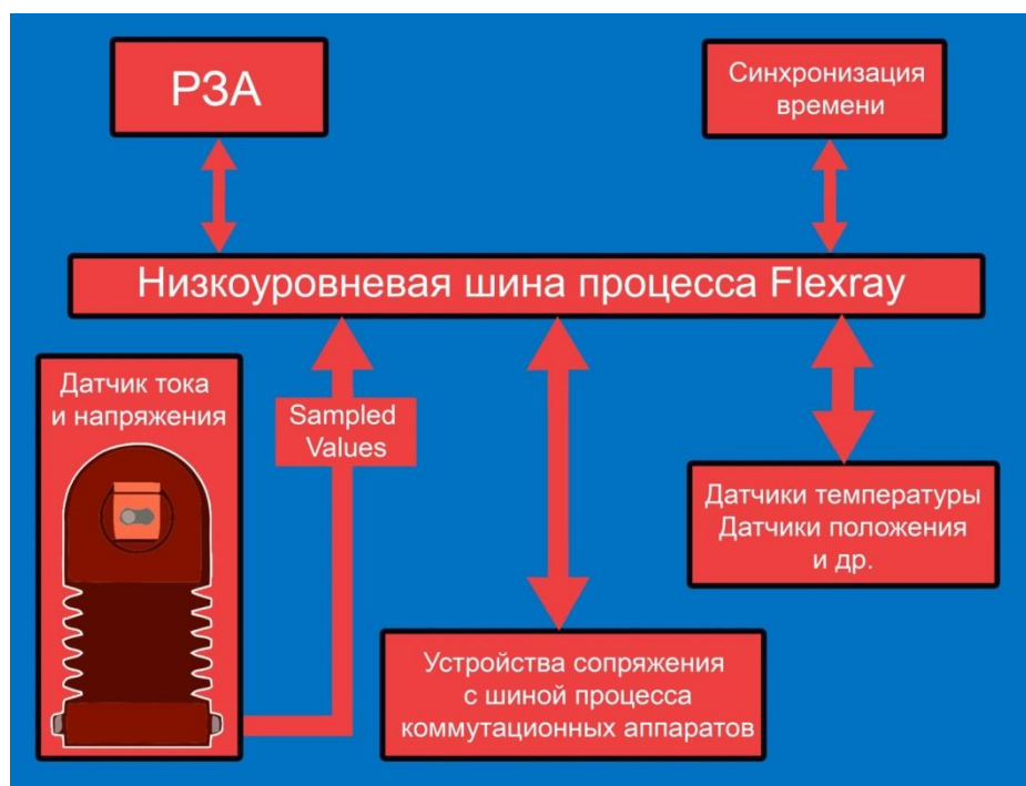
Рис. 3. Низкоуровневая шина процесса и подключаемые к ней устройства в ячейке ESGEAR
