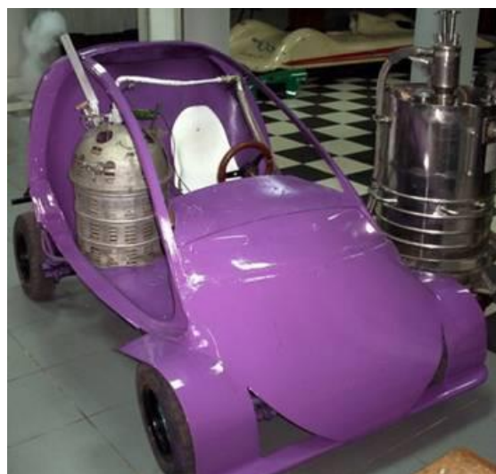
Рис. 2. Заправка криогенного автомобиля жидким азотом
