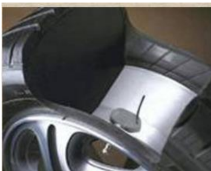
Рис. 1. Сенсор в клапане шины
