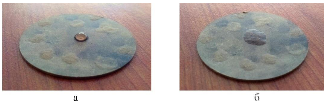
Рис. 8. Поверхность образца скопа: а – капля воды на поверхности образца, б – след набухания после впитывания капли воды
