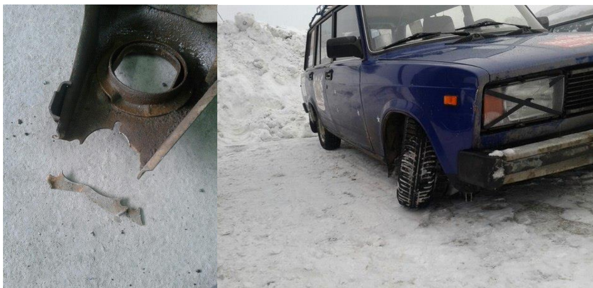
Рис. 1. Рычаг, сломанный на ровной поверхности на трассе для соревнований
