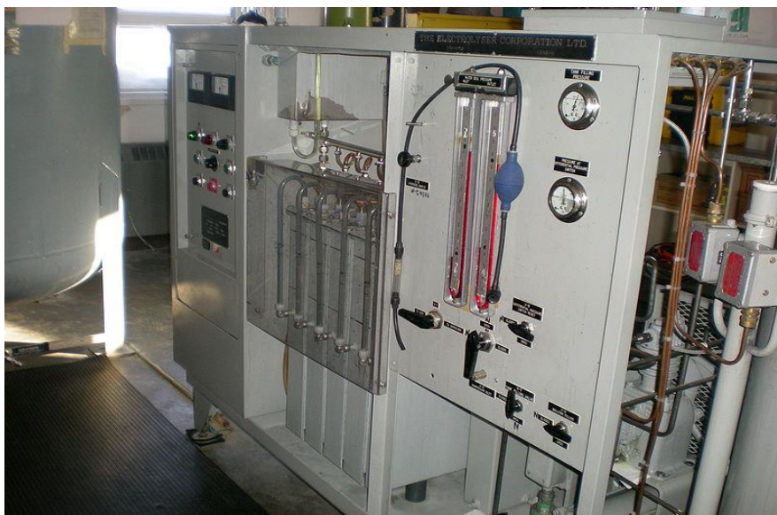
Рис. 1. Электролизёр — оборудование для производства водорода из воды
