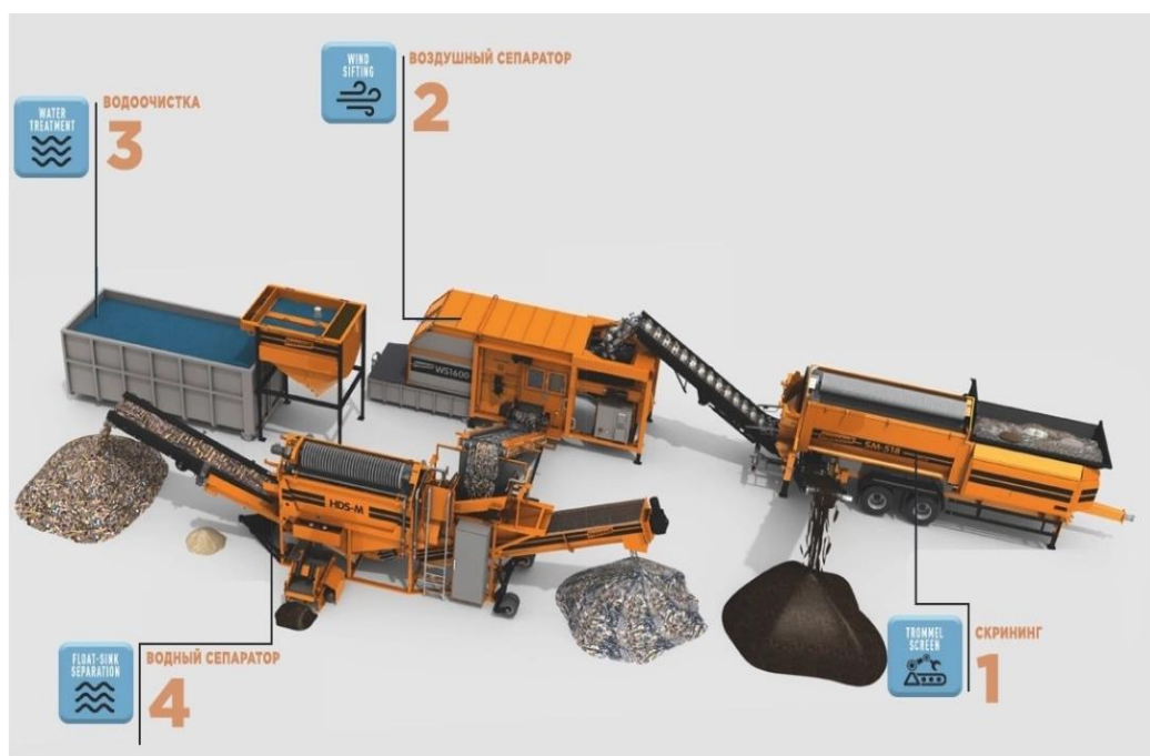
Рис. 2. Мобильный комплекс по переработке отходов строительного мусора
