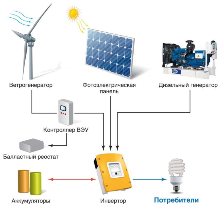
Рис. 1. Схема гибридной системы энергоснабжения
