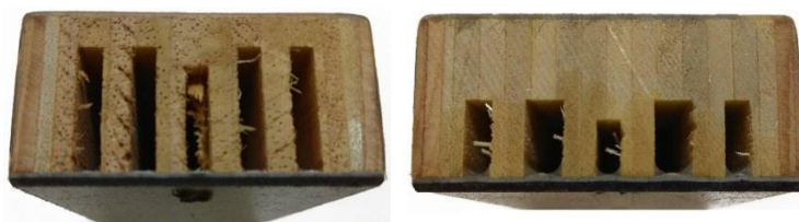
Рис. 3. Пример средних клиньев из древесины с воздушными каналами различной высоты
