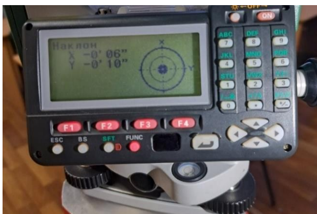
Рис. 1. Электронный уровень тахеометра и круглый уровень трегера
