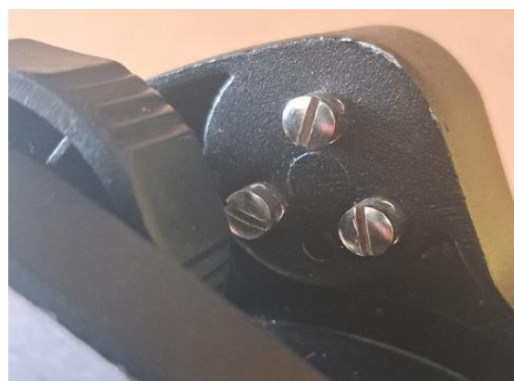
Рис. 2. Юстировочные винты круглого уровня трегера
