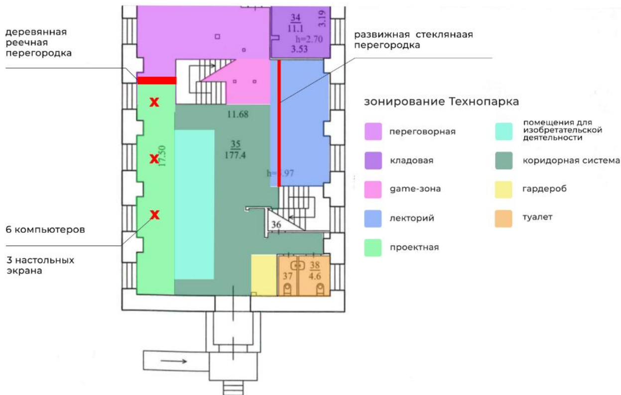
Рис. 5. Расстановка перегородок и экранов в здании Технопарка
