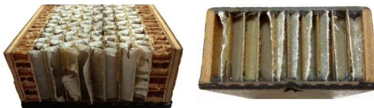
Рис. 4. Пример средних клиньев изготовленных с применением сотовых наполнителей
