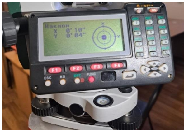
Рис. 3. Юстированный круглый уровень трегера и электронный уровень тахеометра
