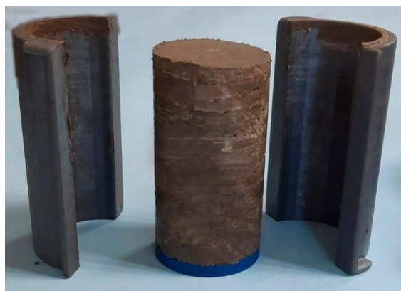
Рис. 3. Образец закрепленного грунта после извлечения из гильзы
