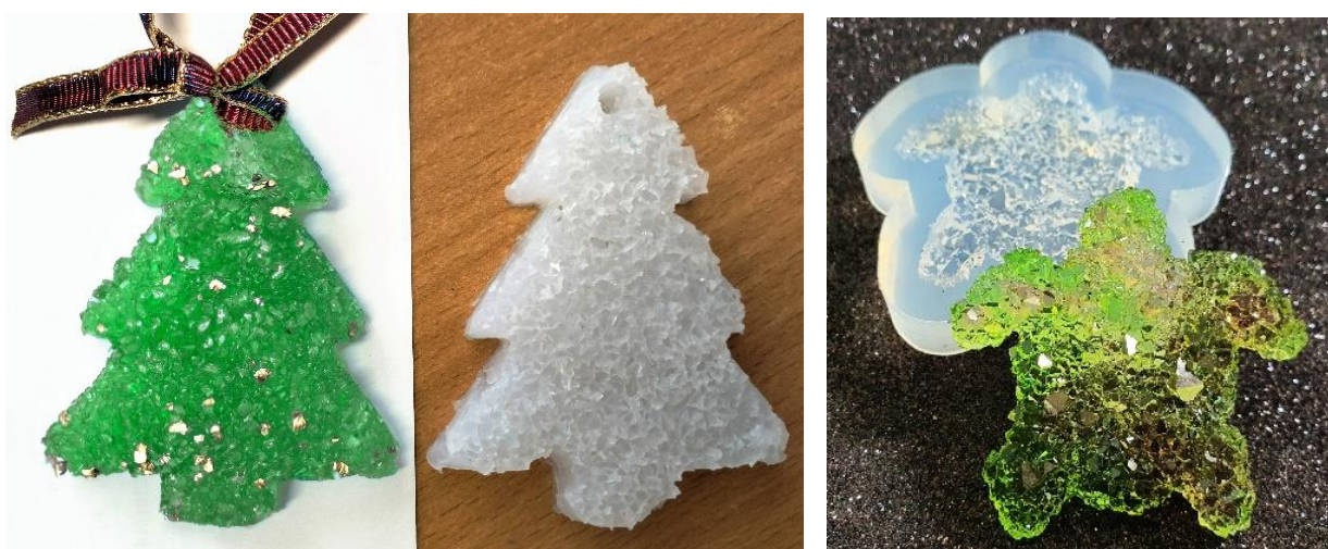
Рис. 4. Применение друзовых молдов для изготовления фигурных изделий из эпоксидной смолы
