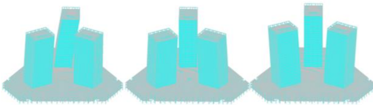
Рис. 5. Деформации здания от ветрового воздействия
