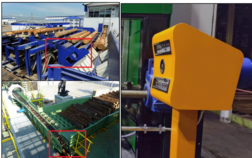
Рис. 6. Возможные места установки и защитный корпус камеры
