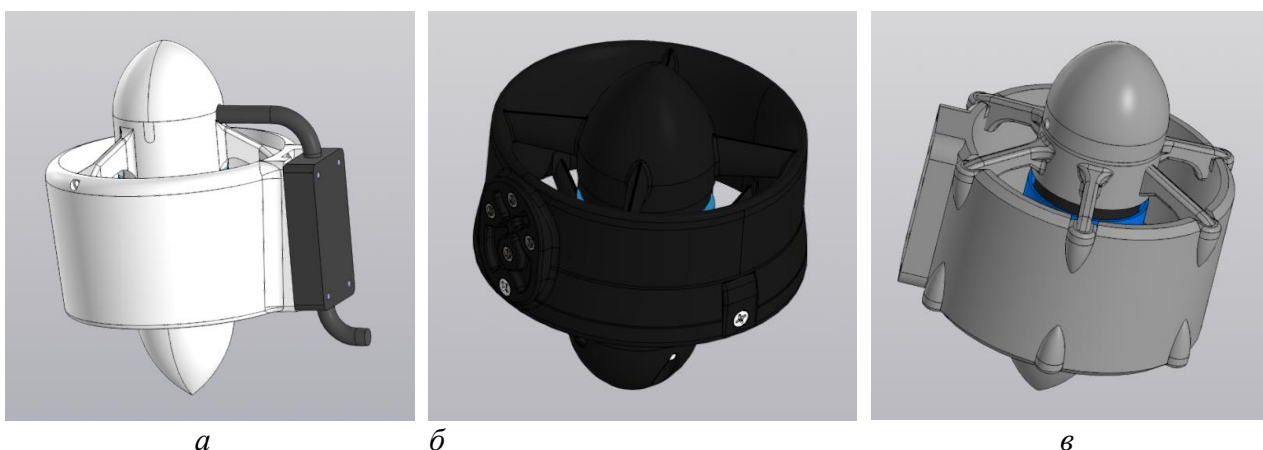
Рис. 6. Движители промышленной разработки ROVMaker ( a ) и Blue Robotics ( б ) и движитель, выполненный с использованием комплектующих промышленного производства и самодельным обтекателем ( в )
