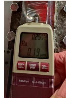
Рис. 8. Измерение шероховатости поверхности
