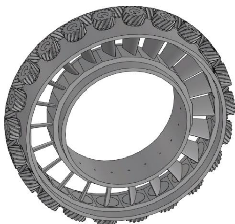
Рис. 2. Модель аксиально-лопаточного завихрителя с поворотным механизмом
