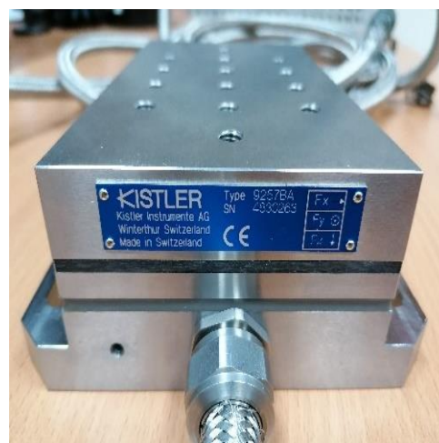
Рис. 2. Трехкомпонентный динамометр Kistler 9257BA
