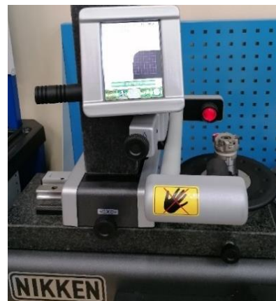
Рис. 5. Прибор для настройки инструмента на исполнительные размеры вне станка и для измерения износа режущих кромок инструмента
