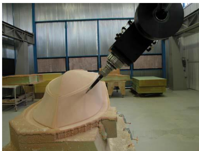
Рис. 2. 50 метровая моторная яхта и заготовка корпуса, обработанная на 3D фрезерном станке из файла «Rhino»
