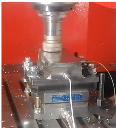
Рис. 4. Общий вид рабочей зоны станка с установленными на столе станка динамометром и заготовкой, в шпинделе станка – фрезой
