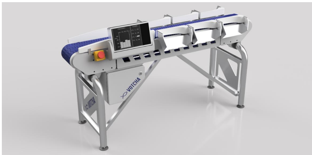
Рис. 1. 3D-модель компактного грейдера
