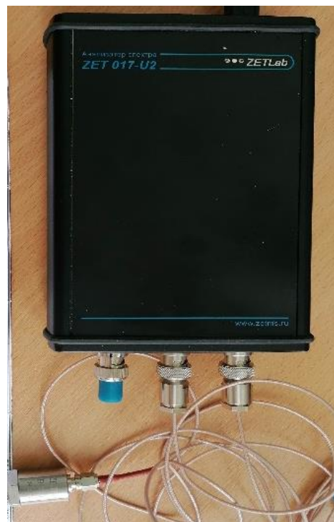
Рис. 1. Виброанализатор с акселерометрами
