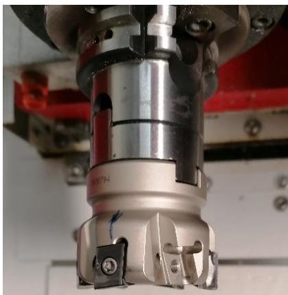
Рис. 3. Фреза с установленным полным комплектом режущих пластин и с 2-мя режущими пластинами для эксперимента
