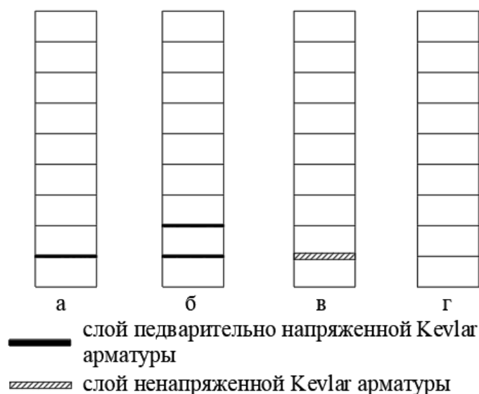
Рис. 1. Сечения испытываемых банок: а, б, в – армированные Kevlar арматурой; г – контрольные неармированные.
