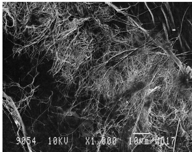
Рис. 4. Фото РЭМ образца, полученного методом поверхностного нанесения при увеличении \times 1000 . Снято со стороны нанесения бактериальной целлюлозы
