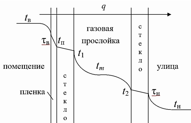
Рис. 1. Расчетная схема распределения температур в оконном блоке
