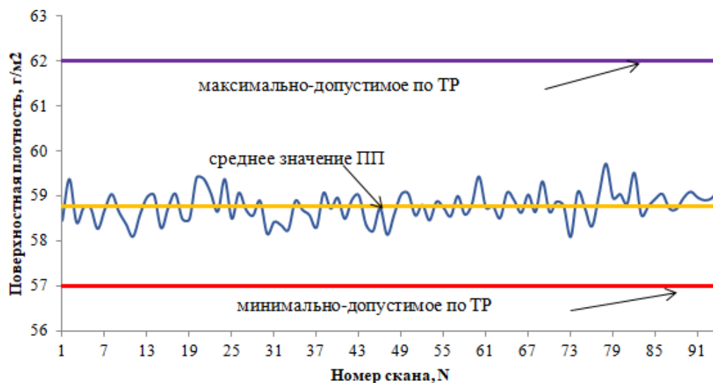
Рис. 2. Профиль ПП бумажного полотна в машинном направлении
