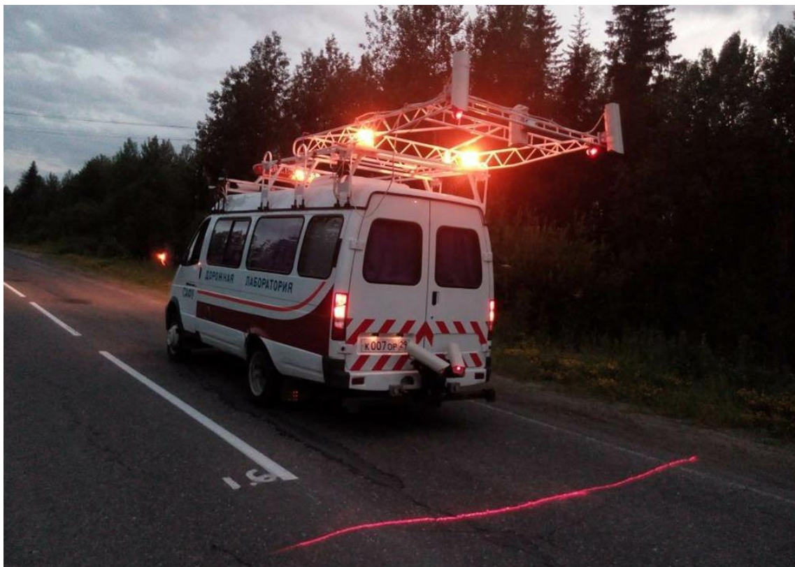
Рис. 1. ПДЛ «ТРАССА» САФУ в режиме измерения поперечной ровности покрытия в ночное время
