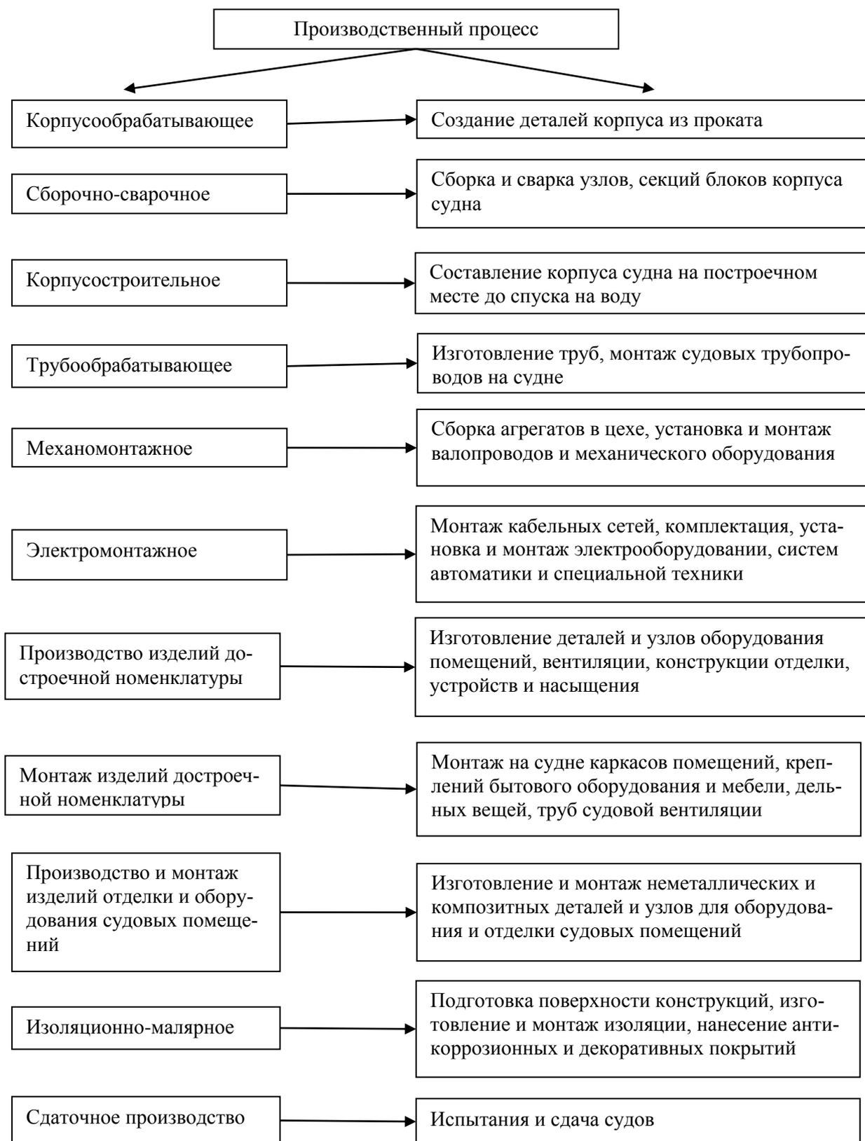
Рис. 3. Характеристика производственного процесса по видам производства
