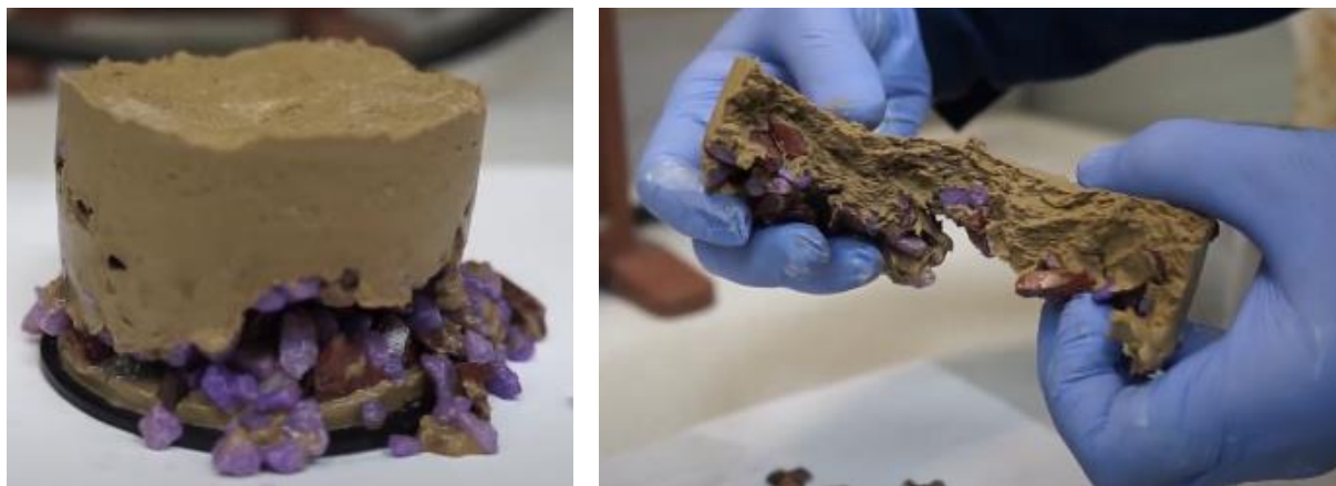
Рис. 2. Результаты испытания в лабораторных условиях быстрофильтрующего состава
