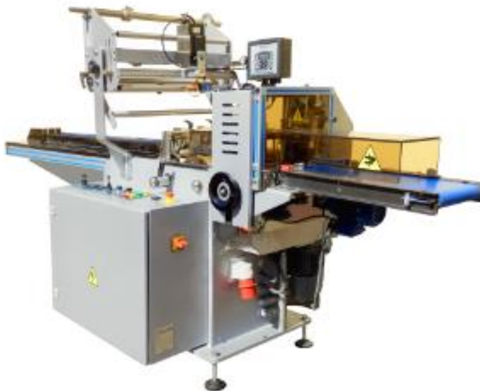
Рис. 3. Упаковочная машина «Бестром-110-3М»
