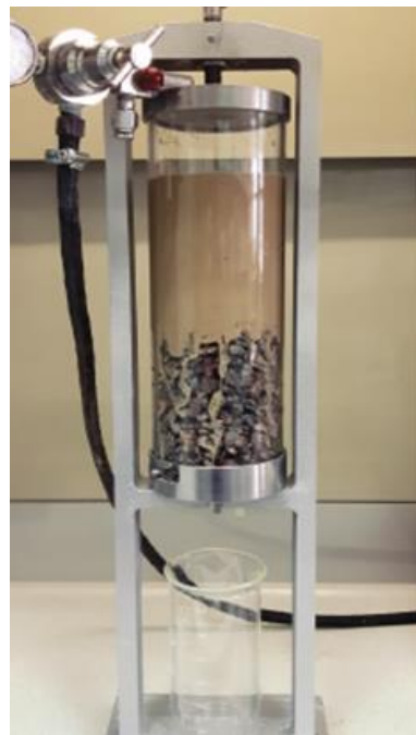
Рис. 1. Испытания в лабораторных условиях быстрофильтрующего состава «BIT-Plug»
