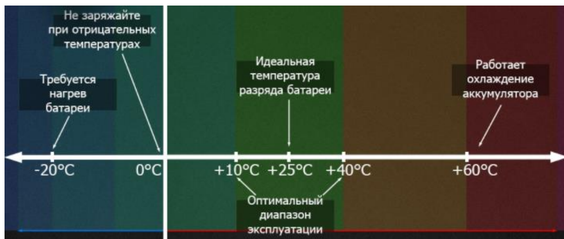
Рис. 2. Оптимальные температуры для батареи электромобиля
