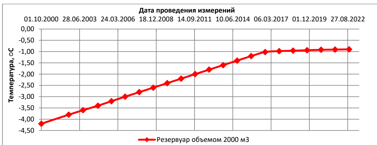
Рис. 5. Изменение температуры грунта на глубине заложения фундамента резервуара объемом 2000 м 3 (2000 – 2006 и 2007 – 2022 годы)
