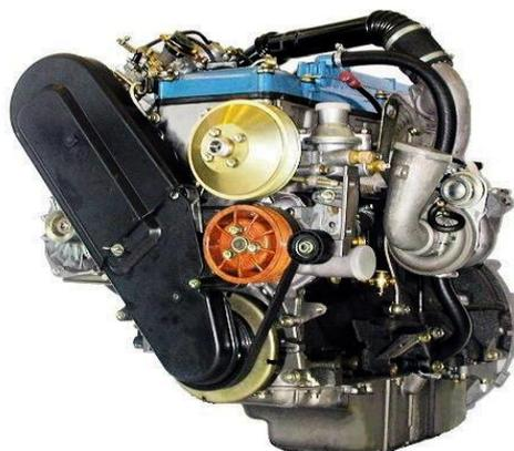
Рис. 2. Двигатель ЗМЗ-5143.10
