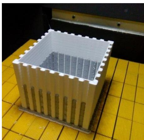
Рис. 2. 3D-печать элементов сборного макета
