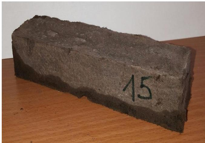
Рис. 1. Теплоизоляционный композит со следующим содержанием компонентов: ССМ-15%, базальтовые волокна -85%, полученный при температуре 105 °С
