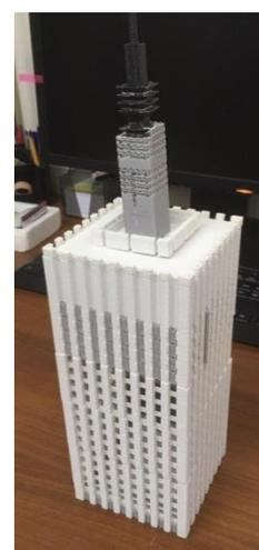
Рис. 3. Конечная модель здания, выполненная на 3D принтере
