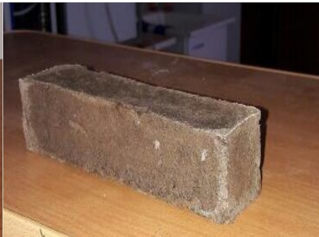
Рис. 2. Теплоизоляционный композит со следующим содержанием компонентов: ССМ-20%, базальтовые волокна -80%, полученный в результате термической модификации
